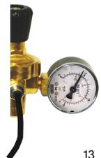
**Verwenden Sie das Gerät niemals ohne Stickstoffzufuhr oder mit einer leeren Flasche, da dies das Gerät dauerhaft beschädigen und den Sterilisationsprozess behindern kann.**
